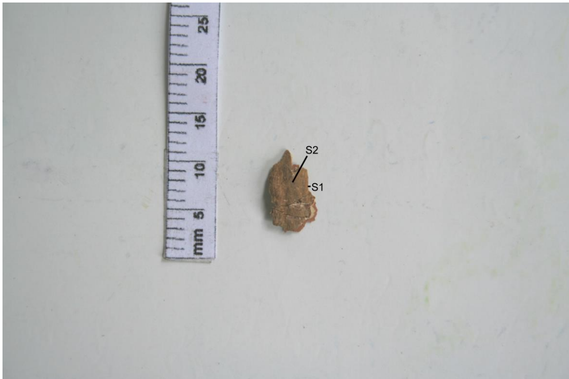
Befund 3 Farbschollenentnahme an der Fenstereinfassung aus Holz am Fenster rechts außen im 1.OG, Westfassade:
